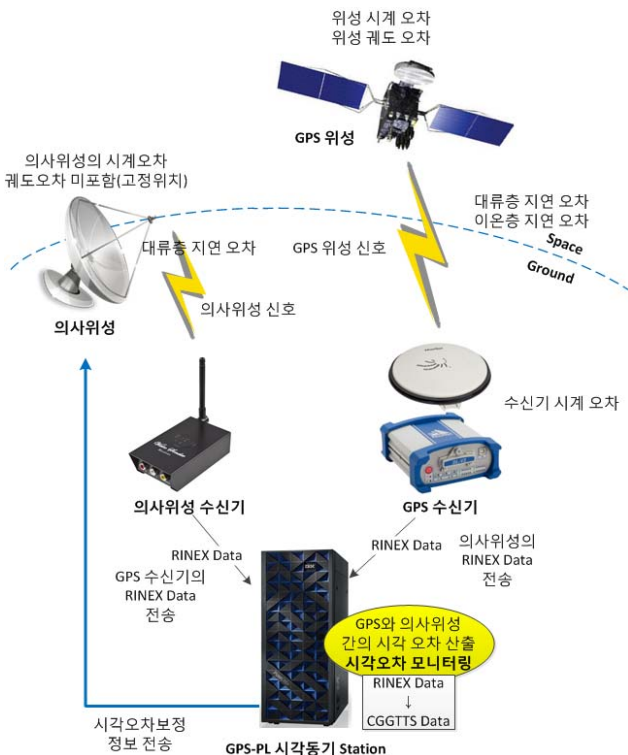
그림 2. 의사위성 시각동기 스테이션 구축 방안 Fig. 2. The method using pseudolite time synchronization station.
