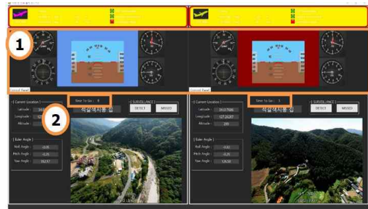
그림 10. 적응형 기능 활성화 무인기 제어화면 Fig. 10. UAV control GUI of adaptive function activation GCS.
