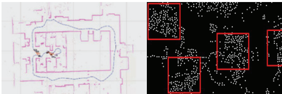
그림 9. 실내 위치 측정 지역 패치 위치 결과 Fig. 9 Indoor localization area patch location result
