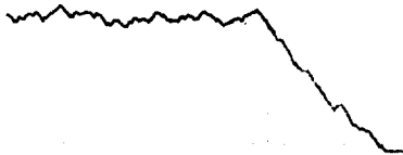
그림 8. 핑크노이즈를 1KHz 대역통과시켜 기존 방식에 의해 얻어진 감쇄곡선
