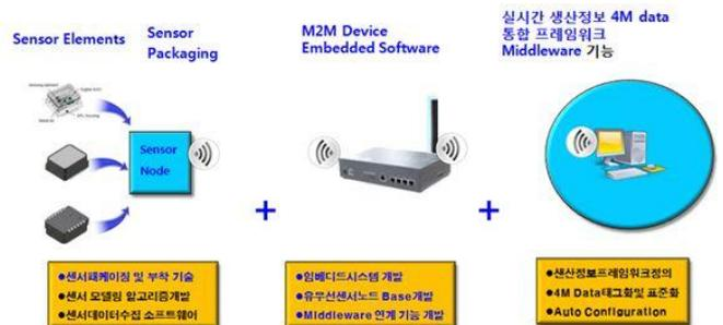
Fig. 2 센서 융합 시스템 구성 요소
