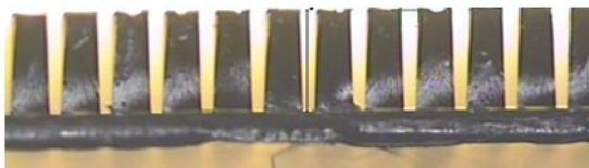
Hard mold 적용 고형상비 미세 패턴 성형 (패턴 : 143 ~ 163 \mu m, 형상비 : 2.5 ~ 3)
