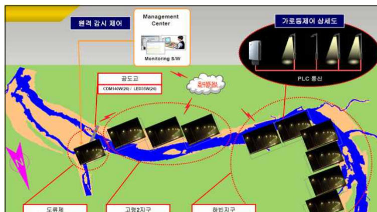
<그림1. 강정고령보구간 가로보안등 제어시스템 구축범위>
