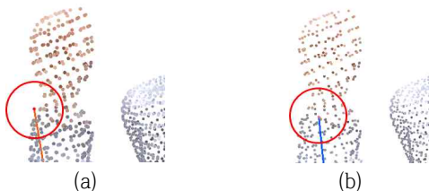
그림 4. (a) 보정 전의 객체 바깥쪽에 위치한 조인트 (b)보정 후에 객체 내부로 이동한 조인트
