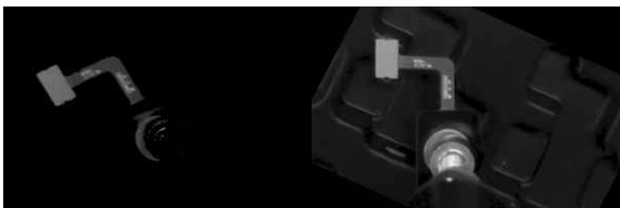
Figure 8. 결과 각도를 이용해 Reference 이미지를 회전시킨 이미지와 결과에 -1을 곱해 Rotation 이미지를 회전시킨 이미지
