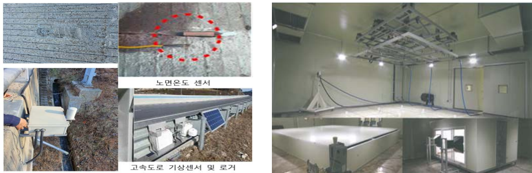
Fig. 1. 도로기상관측시스템(좌) 및 기후환경실증실험(우).
