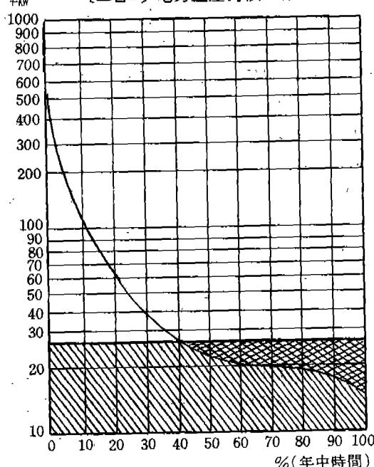
이 된다. 그러나 年 8,760시간 어느 時點에서나  $30\text{m}^3/\text{초}$ 는 초과한다.  $60\text{m}^3/\text{초}$  이상이 되는 曲線以下 부분은 約 1,615百萬 $\text{m}^3$  정도인데, 落差를 가정하고, 電力賦存公式  $P_i = 9.8QHE$  를 適用하면 流水持續曲線은 電力生產 持續曲線(Power duration curve)으로 바꾸어 놓을 수 있다. <[그림 B참조]>
