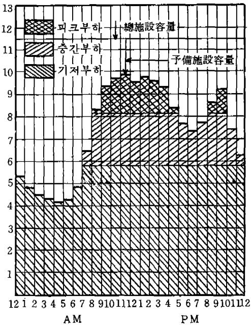
는 中間負荷이다. 비교적 하루 중 長期間에 걸쳐 일어나는 負荷이며 보통 既存의 火力과 水力發電所에 依해 供給된다. 總系統能力은 피크負荷보다 크며 一定量의 發電容量은 系統에서 他稼動中인 發電所의 事故에 대비하여 予備로 保有되어야만 한다. 보통 總系統容量의 約 15% 가豫備로 保有된다. 지금까지는 系統의 負荷를 時間別로 보았는데 同一負荷를 持續時間概念으로 보면 負荷持續曲線으로 表示될 수도 있다. 負荷持續曲線을 負荷率과 時間으로 나타낼 때, 장래의 여러가지 양상에 어떻게 대처해야 할 것인가라는 解決策을 나타내 준다.
