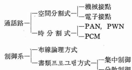
通話路가 時分割(TDM) PCM 方式이고 蓄積프로그램方式의 制御系를 가진 電子交換機를 디지털交換機라고 한다.
