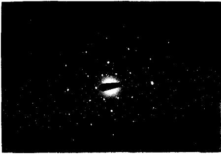
그림 1. 1 \times 10^{14} \text{ N}_2^+/\text{cm}^2 주입된 Al 박막의 TED pattern.
