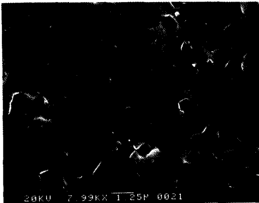
그림 3. Surface morphology of CdS film annealed in In atmosphere. (Annealing temp. 400°C).
