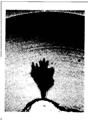
〈그림 3.12〉 CV케이블 절연체 중의 水트리(內導 테이프층에서 발생된 例)
