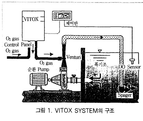
그림 1. VITOX SYSTEM의 구조
