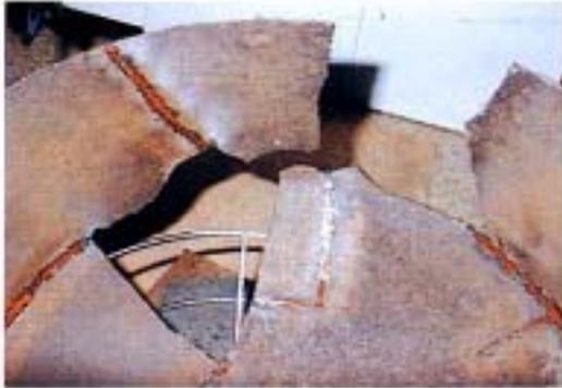
Photo 13. 드럼 C 파손부분 용접 상태
