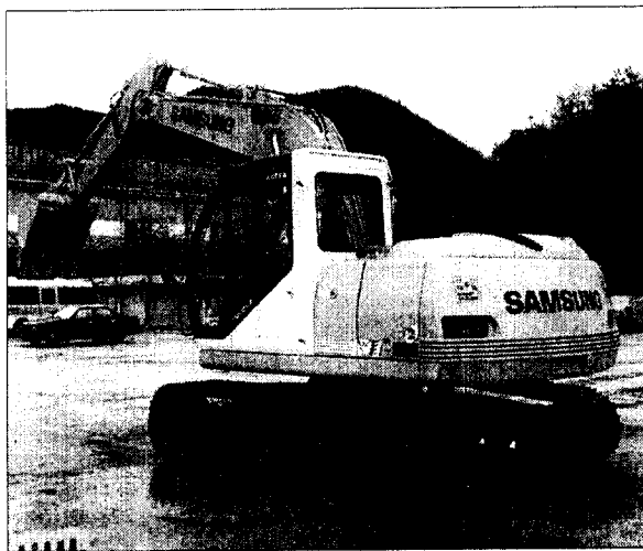
그림 4-1. FRP를 적용한 엔진후드(MX6LC)
