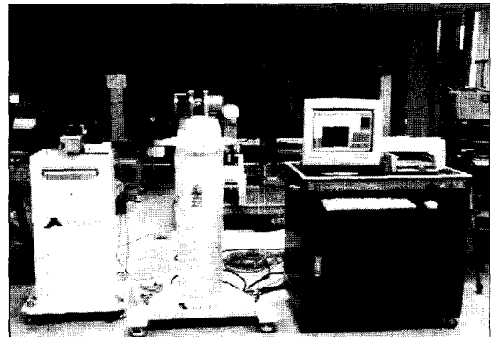
그림 5. 시제품으로 개발된 LTS. Fig. 5. Developed laser tracking system.
