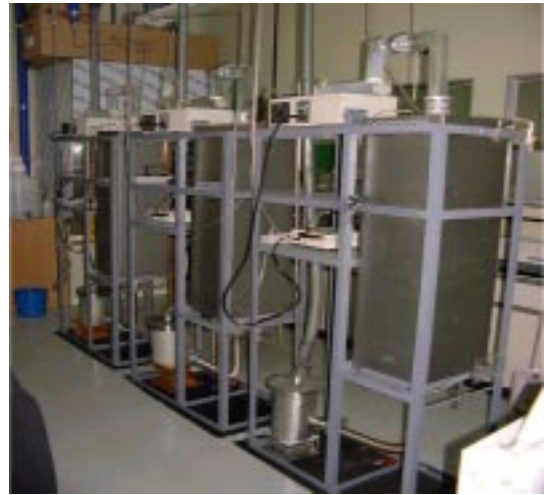
〈그림 10〉 파일럿 규모의 초음파 분무열분해 장치 모식도 및 설치 사진(한국화학연구원)
