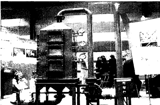
그림. 5 ACF Pilot Plant (처리용량 : 1~6 m 3 /min, 처리대상 : VOCs 및 악취, 통과속도 : 0.1~0.5 m/s, 접촉속도 : 1~5 sec)
