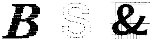
(a) 점글꼴 (b) 윤곽선 글꼴 (c) 구조적 글꼴 그림 1 점 글꼴과 윤곽선 글꼴, 구조적 글꼴의 예
