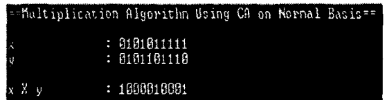
그림 6 정규기저 표현의 곱셈기 구현 예 Figure 6. Example of implementation of multiplication on normal basis
