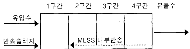
그림 1. A 하수처리장의 폭기조를 A2/O 공정으로 개조
