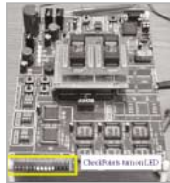
[그림 9] FPGA검증용 에뮬레이션 보드의 구조 및 사진
