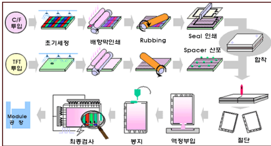
그림 3. TFT-LCD의 제조공정
