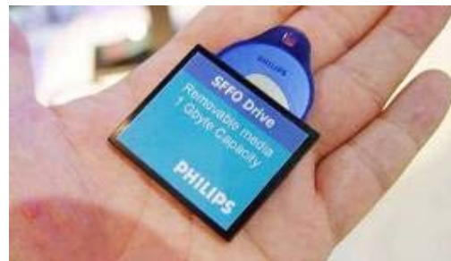
(그림 4) Philips사의 청색레이저 초소형 디스크드라이브 Portable Blue의 형태
