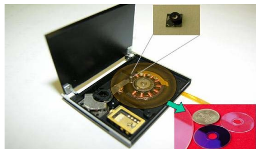
(그림 5) ETRI의 연구과제로 수행한 초소형 광디스크 드라이브(CF-II 규격)
