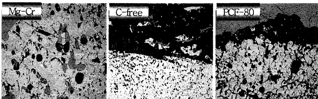
<그림 5> 시멘트 Cl' Coating 시험 후 가동면 SEM 사진
