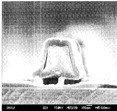
그림 4. Si 3 N 4 로 passivation 한 후에 제작된 100 nm T-게이트 단면 SEM 사진.
