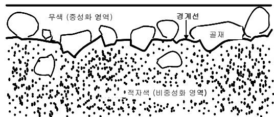
Fig. 4 축진 중성화 깊이 측정 방법
