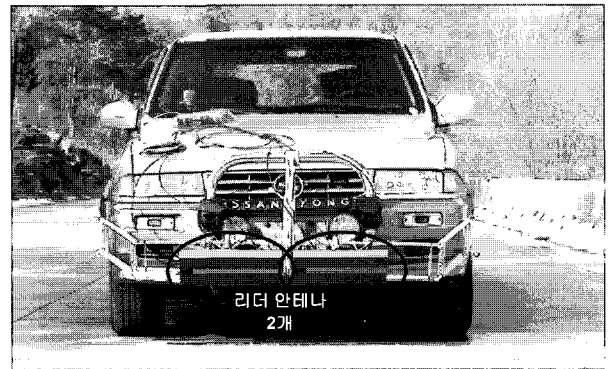
그림 12. RFID 시스템이 장착된 실험 차량. Fig. 12. Test vehicle equipped with a RFID system.
