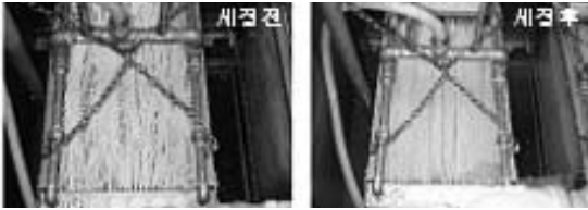
(그림 5) 약품세정 전, 후 중공사막 상태
