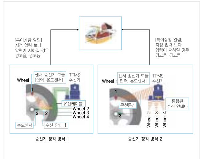
〈그림 10〉 자동차 압력 경보 시스템 개념도
