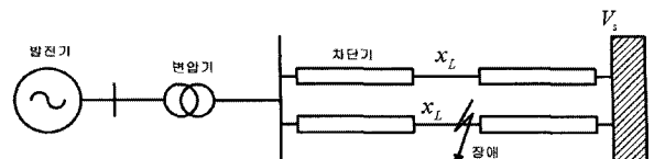
그림 1. 1기 무한 모선 모델. Fig. 1. Single machine infinite bus model.
