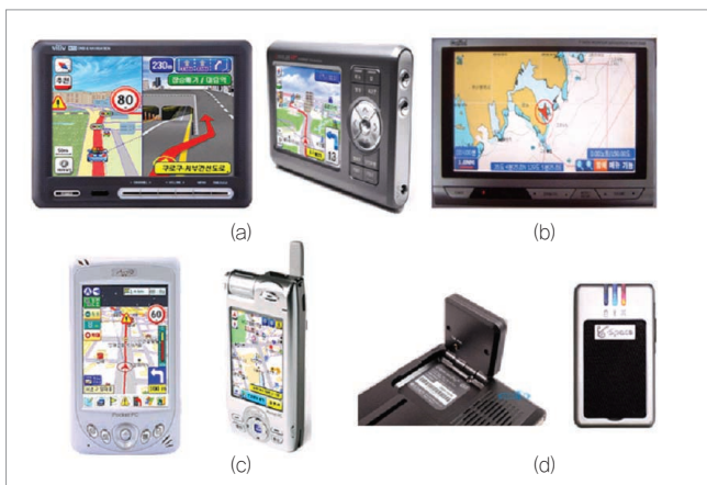
주: (a) 자동차 운전자용 내비게이션, (b) 선박용 내비게이션, (c) PDA 및 스마트폰 탑재형 내비게이션, (d) 위성항법시스템 수신기(GPS 안테나)
