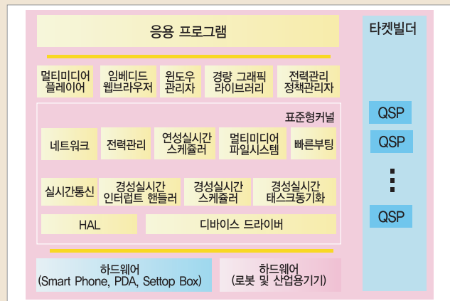
(그림 1) 임베디드 운영체제 Qplus 구조도
