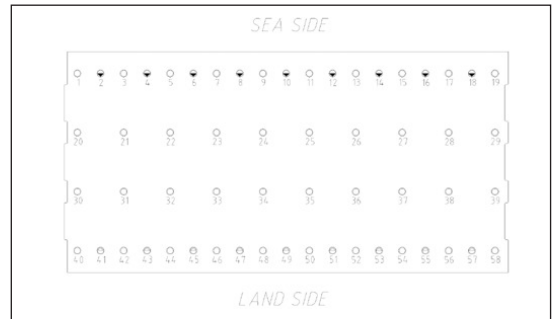
그림 10. Deck Pile 배치도
