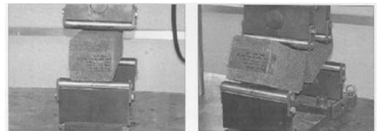
그림 5 휨강도시험 후 시험체
