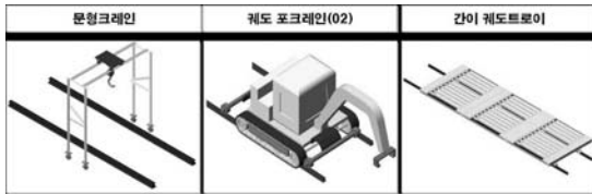
그림 12 도상흡음판 시공 및 운반에 필요한 장비
