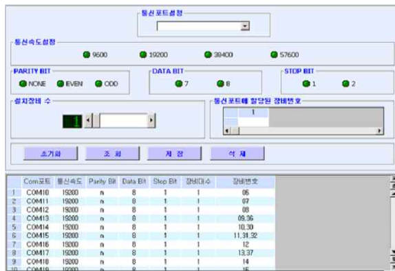
그림 9. 리더기와 통신을 설정하는 화면 Fig.9 Screen for Communication Setting up with RFID Readers
