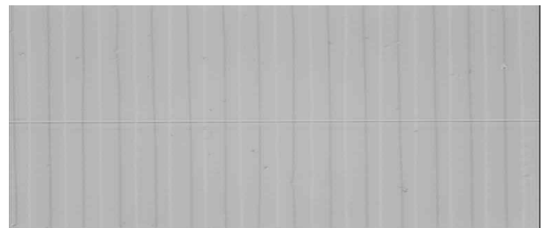
그림 4. HF 식각을 통해서 분극반전 공정 후 Ti:PPLN 표면 사진
