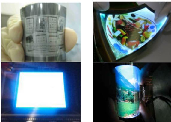
[그림 1] (a) Toppan Printing(흑백 EPD), (b) LG 전자(서스 기판상에 제작한 flexible AMOLED), (c) ETRI(arylite 기판상에 150℃ 공정으로 제작한 ZnO TFT), (d) SMD(용액공정 폴리이미드 상에 제작한 IGZO TFT)
