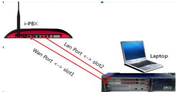
그림 6. 동시통화 수 측정 개념도 Fig. 6. The conceptual diagram of measuring the number of simultaneous telephone calls
