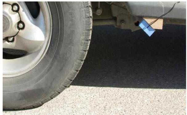
그림 3. 초음파신호 획득을 위한 센서 설치
