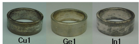
[그림 8] 고온산화 후의 산화물 형성 결과
