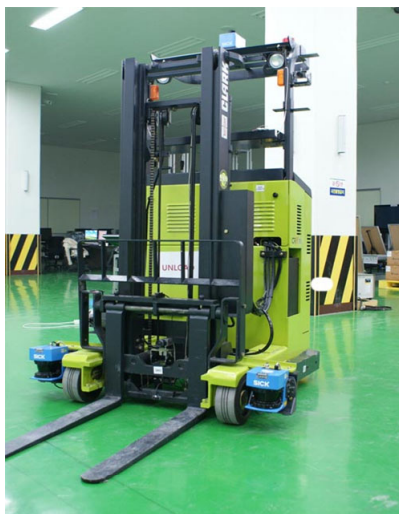
그림 3. 자율주행을 위한 센서와 액추에이터를 설치한 CLARK사의 CRX-10 지게차 실험모델.
