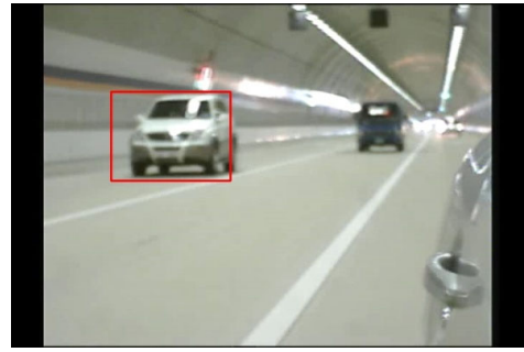
그림 6. 그림 1(b)의 ROI에 적용된 연쇄적 분류기. Fig. 6. Cascade classifier applied to the ROI generated in Fig. 1(b).
