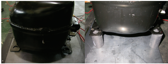
[그림 12] 압축기 모델(좌) 과 재진고무요소(우)
