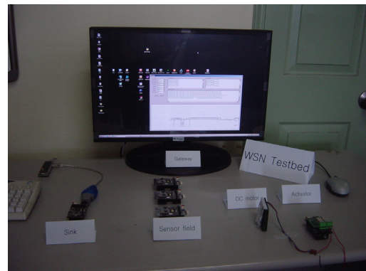
[그림 5] 구축된 WSN 테스트 베드
