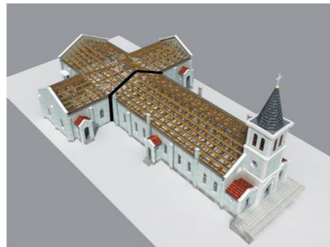
[그림 10] 지붕트러스 3D Digital Model (검은 선은 기존·증축 부분 경계)
