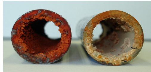
[그림 13] SWRO와 \text{SWRO}+\text{Ca}(\text{OH})_2+\text{CO}_2 +부식억제제에서의 조건에서 탄소강관의 내부 사진(절단 전).
