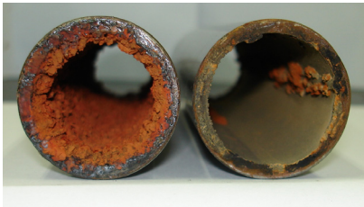
[그림 10] SWRO와 \text{SWRO}+\text{Ca}(\text{OH})_2+\text{CO}_2 의 조건에서 서의 탄소강관의 내부사진(절단 전).
